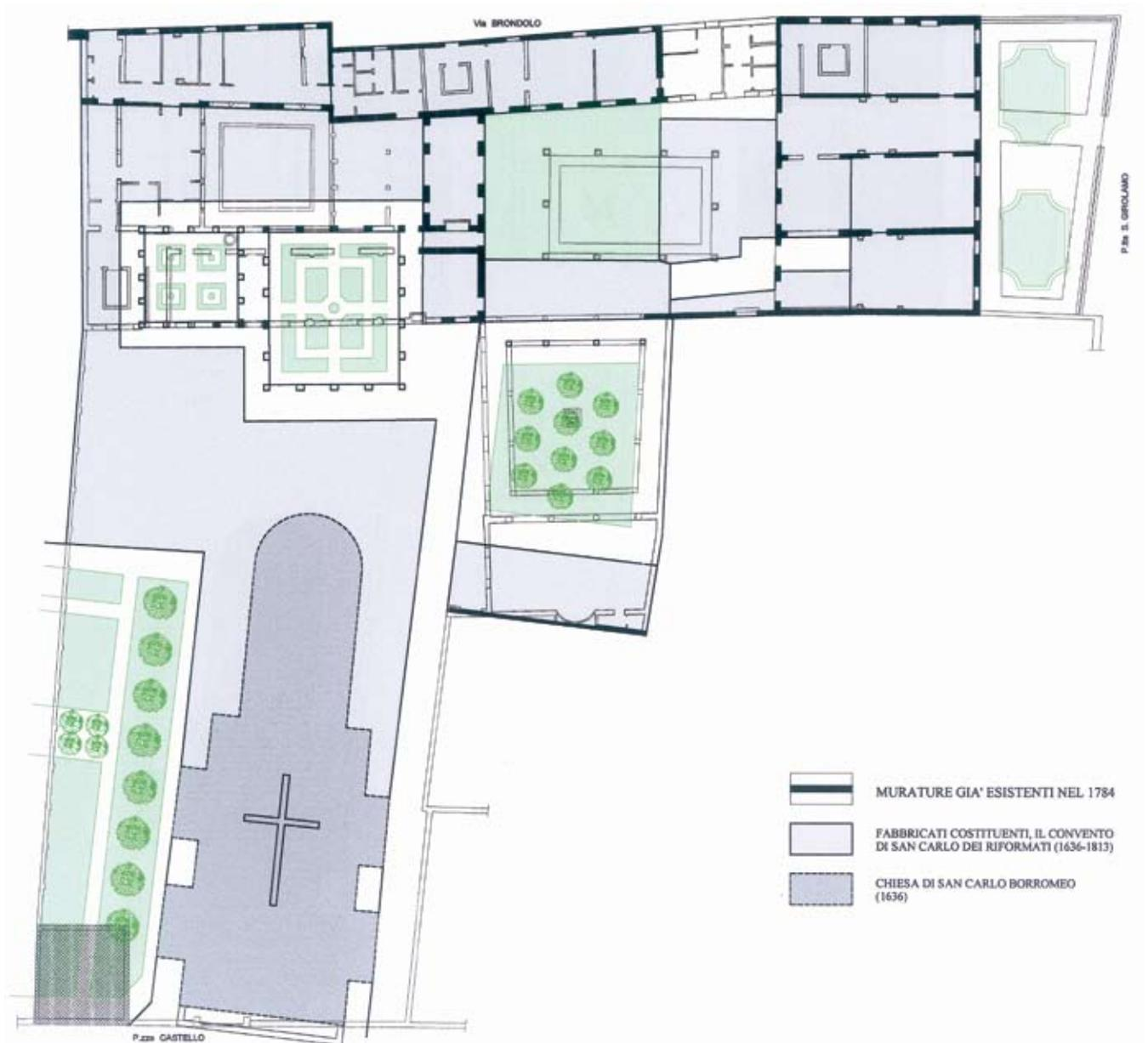
Fig.24 – Pianta attuale dell’attacco a terra con sovrapposizione del disegno desunto dalla Pianta di Giovanni Valle del 1784 con, in nero, le strutture murarie di impianto precedente al 1813
